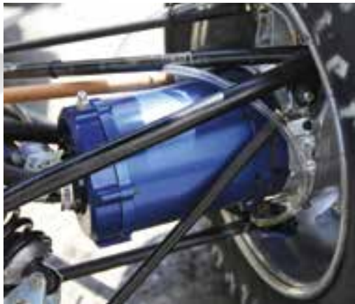
Każde koło napędzane jest niezależnym silnikiem elektrycznym wykonanym ze stali iCARE® Save
